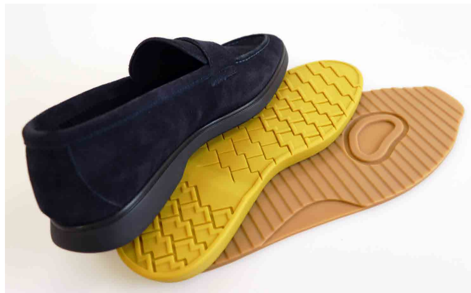
Protótipos das solas biomiméticas inspiradas em estruturas naturais e produzidas em bio-TPU.
